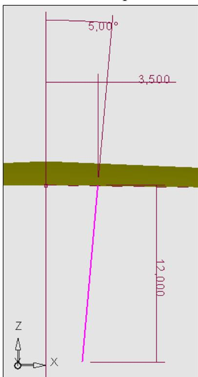
Рисунок 7 – Эскиз контура центральной канавки
