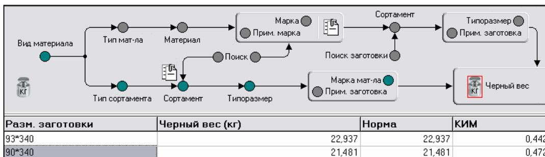
Рисунок 160 – Масса заготовки в случае применения различных типоразмеров сортамента проката
