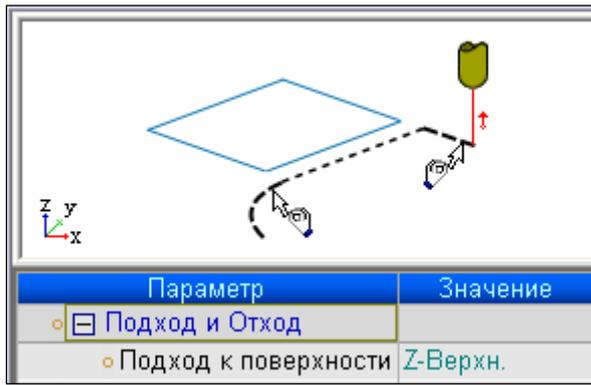
Рисунок 58 – Параметры подхода и отхода инструмента к контуру
