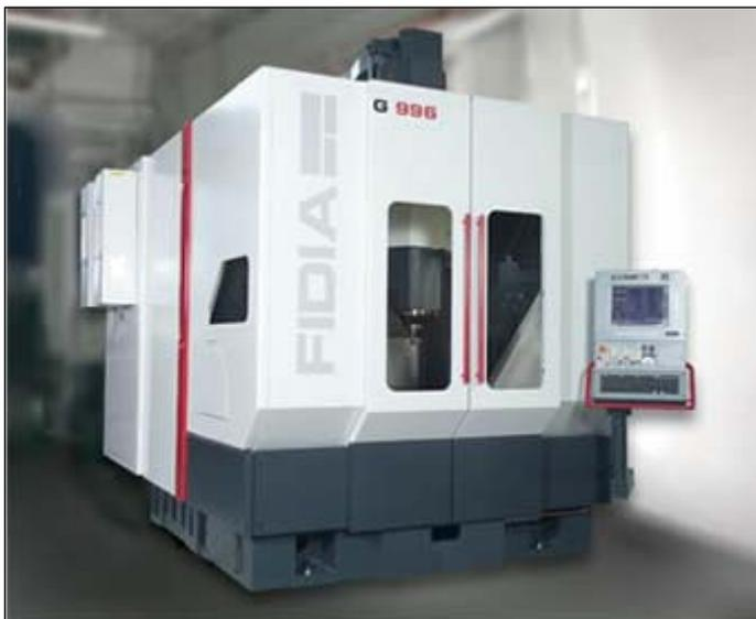
Рисунок 197 – Общий вид высокоскоростного фрезерного обрабатывающего центра G 996
