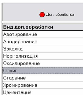
Рисунок 161 – Выбор способа дополнительной обработки детали
