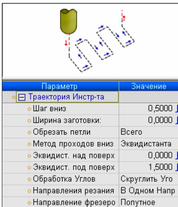
(когда радиус кривизны контура меньше радиуса инструмента). Назначаем скругление углов, фрезерование только в одном направлении (обратно инструмент возвращается по плоскости безопасности), направление резания попутное.
