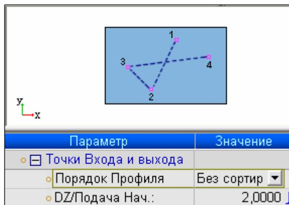
Рисунок 105 – Параметры точек входа и выхода инструмента при контурном фрезеровании по открытому профилю
