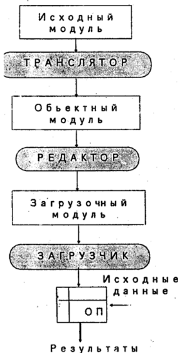
Рис. 4.8. Этапы создания исполнимого модуля
