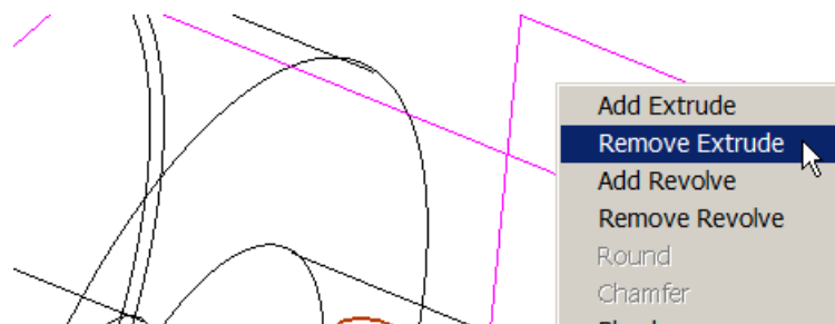
Рисунок 43 – Выдавливание с удалением материала
