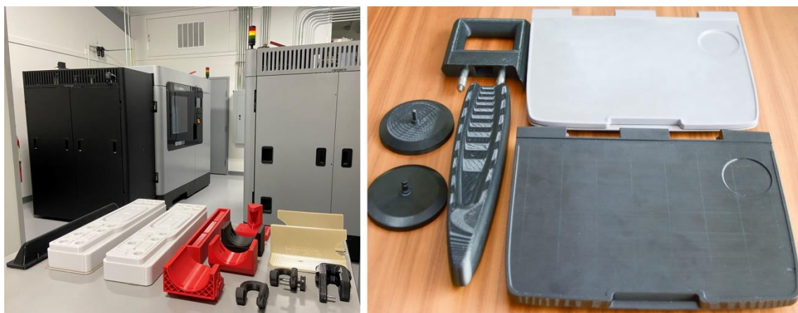
Рис. 11. ЦАТ Siemens Mobility и запчасти вагонов из Ultem, напечатанные на его базе
