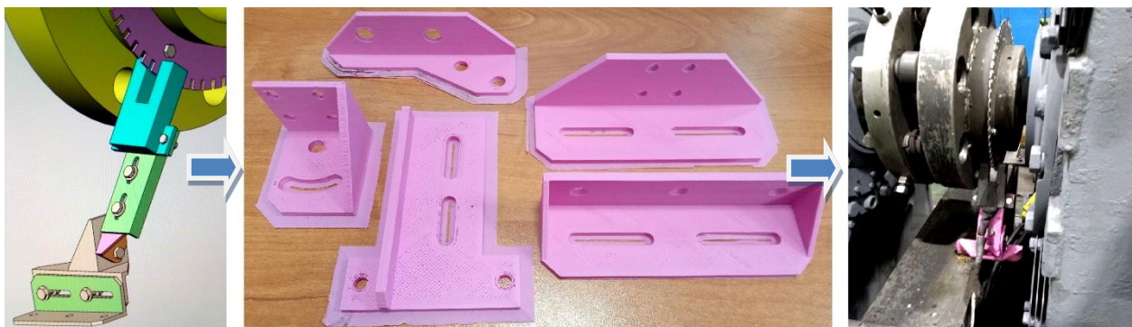
Рис. 37. Стойка датчика частоты вращения ТЭД, напечатанная из PLA
