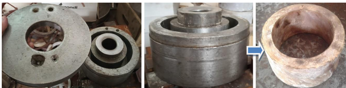
Рис. 24. Пресс-форма в СЛД для литья заготовки полиамидной втулки люлечного подвешивания кузова электровоза серии ВЛ-80с
