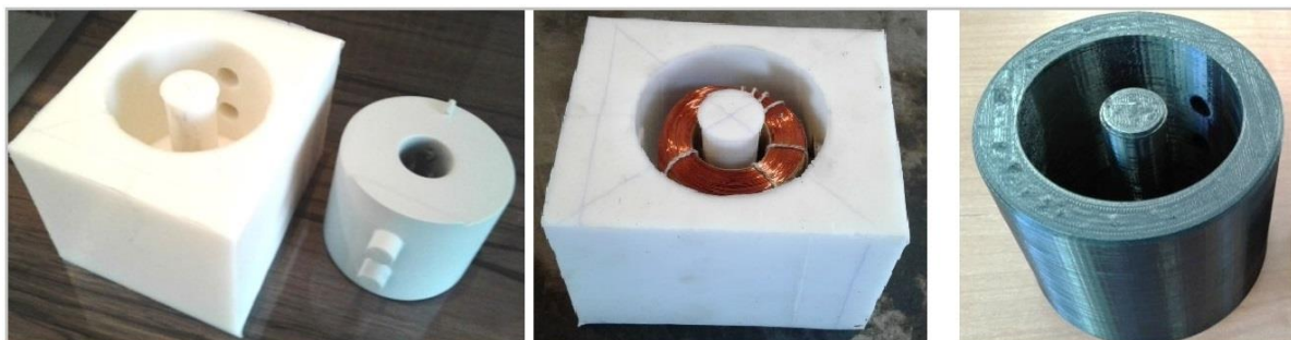
а) б) Рис. 34. Гибкие формы для изолировки катушек: а) Из 2к-силикона; б) Из Flex [29, 30]
