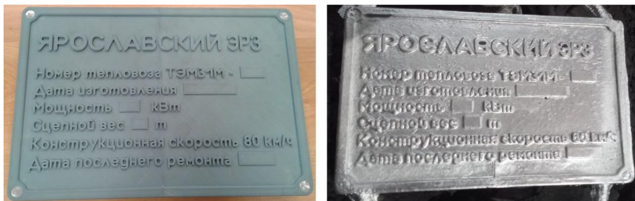
Рис. 28. Модель таблички тепловоза серии ТЭМ31М и готовая алюминиевая отливка
