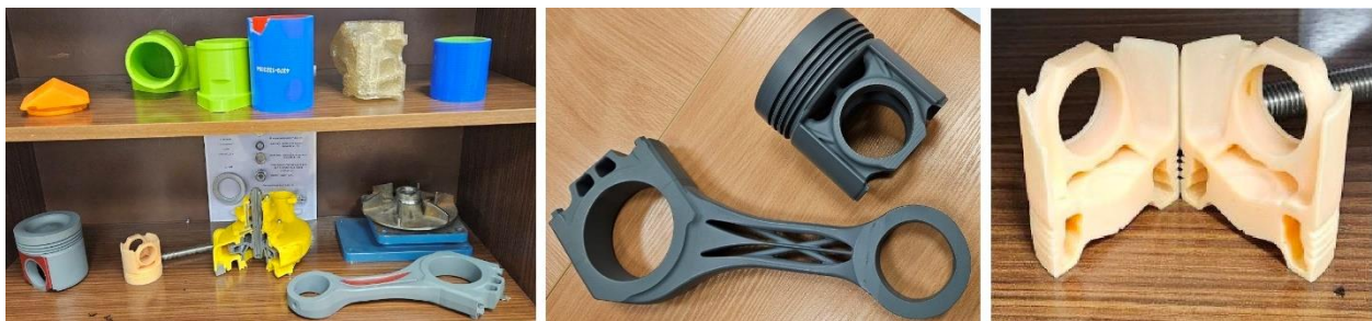
Рис. 9. Макеты оптимизированных деталей ДВС, напечатанные на ООО «УДМЗ»
