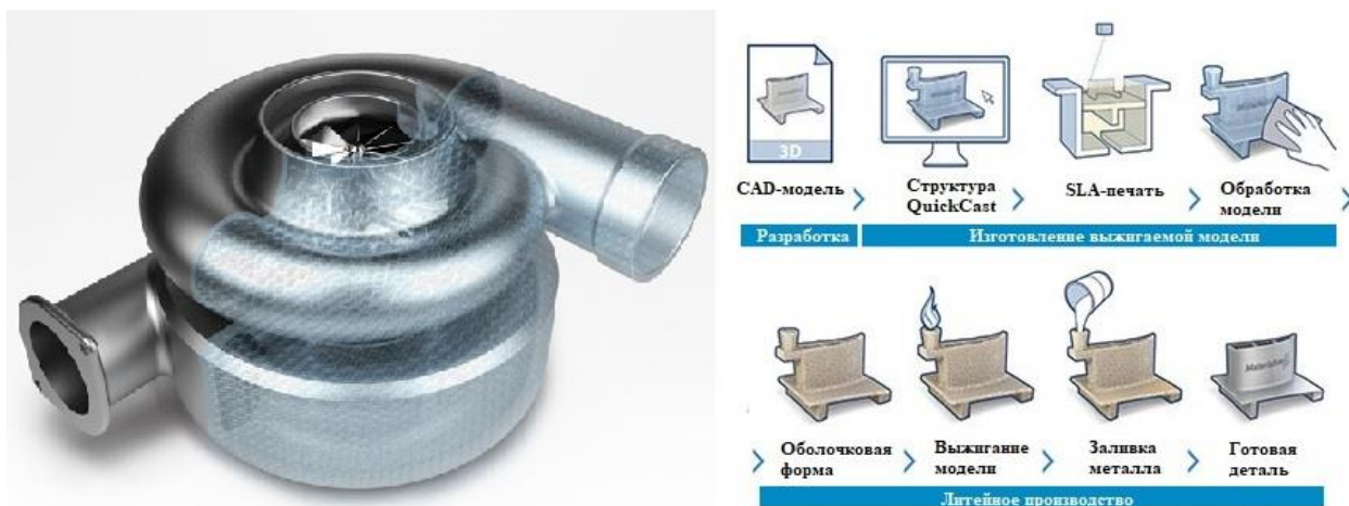
Рис. 10. Изготовление отливки по QuickCast-модели с сетчатой структурой TetraShell
