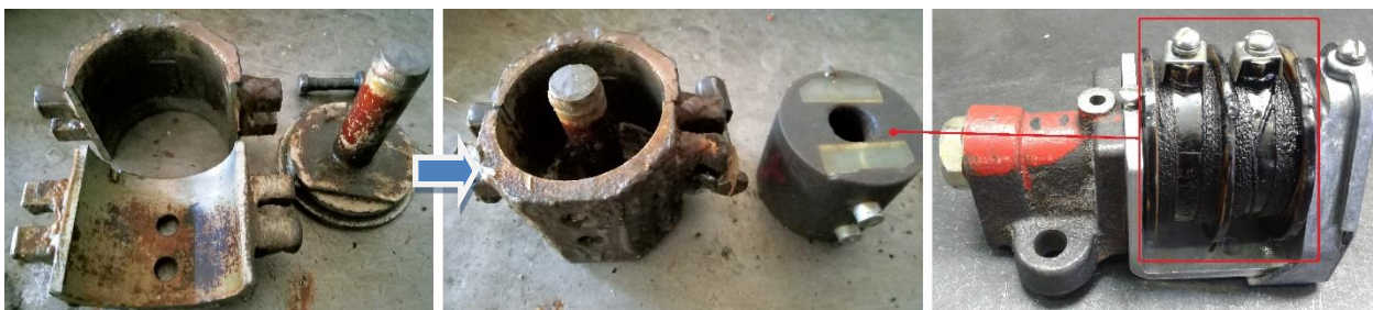
Рис. 33. Изношенная форма изолировки катушек электропневматических вентилях [29, 30]
