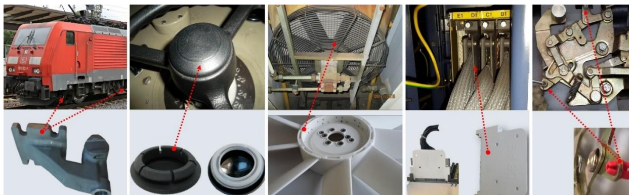
Рис. 14. Запчасти локомотивов, напечатанные в ЦАТ DB на SLS-установках [24]
