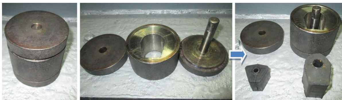
Рис. 23. Пресс-форма в СЛД для вулканизации резиновых втулок
