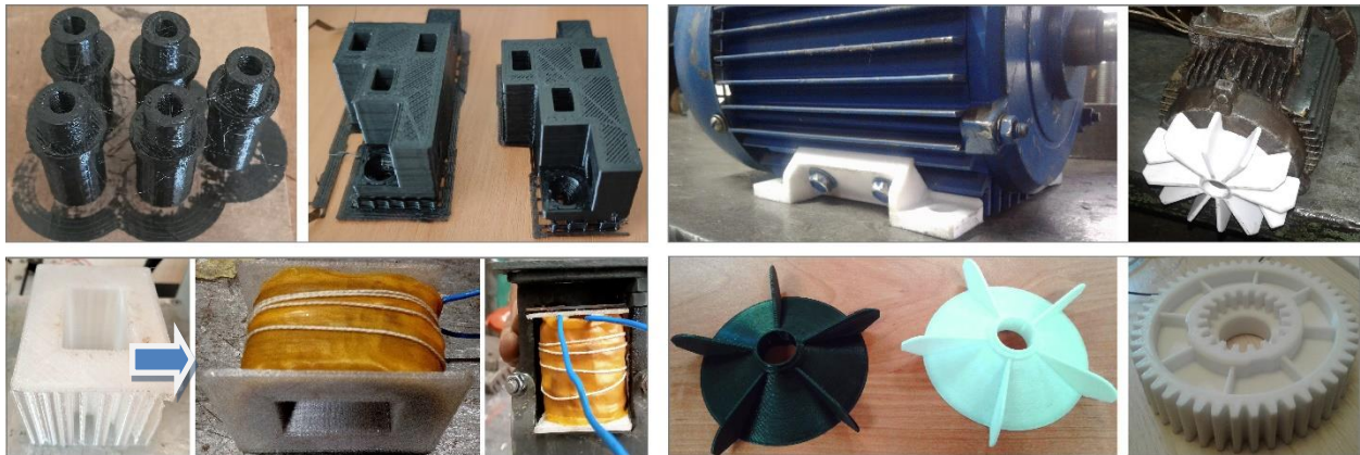
Рис. 26. Запчасти цехового оборудования Ярославского ЭРЗ, напечатанные из PETG
