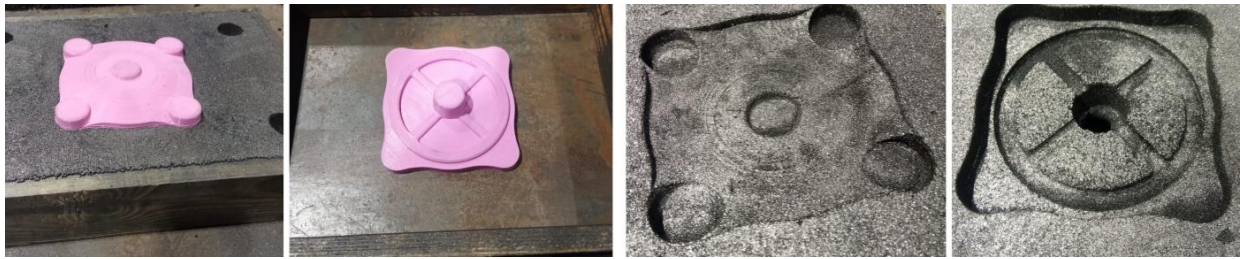
Рис. 30. PLA-модель отливки крышки цилиндра компрессора КТ-6,7
