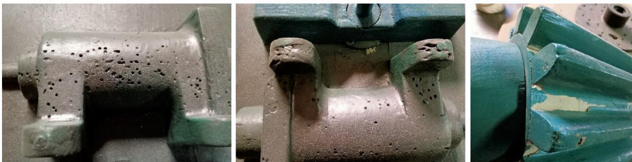
Рис. 29. Повреждения деревянных моделей в процессе эксплуатации
