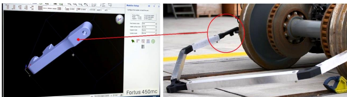
Рис. 12. Сочленения из Ultem в рамке перемещения тележек
