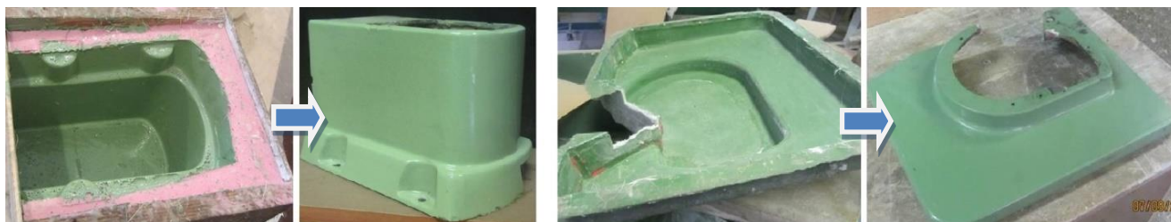
Рис. 20. Матрицы для стеклопластиковых панелей кабины электровоза серии ЭП1М
