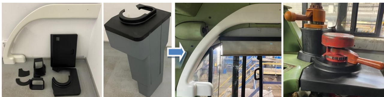
Рис. 6. Запасные панели электровоза серии ЭП1М, напечатанные ЦАТ ООО «Рэйл Альянс» из полифениленсульфида (PPS) на принтерах Raise3D Pro2 [17]
