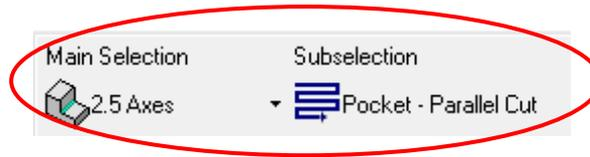
Рисунок 15 – Выбор типа обработки и типа контура черновой обработки
