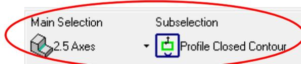
Рисунок 23 – Выбор типа обработки и типа контура для чистовой обработки
