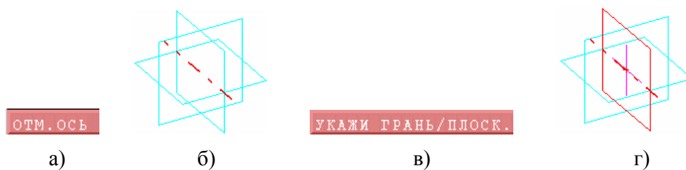
Рисунок 6 – Выбор оси и плоскости построения модели детали
