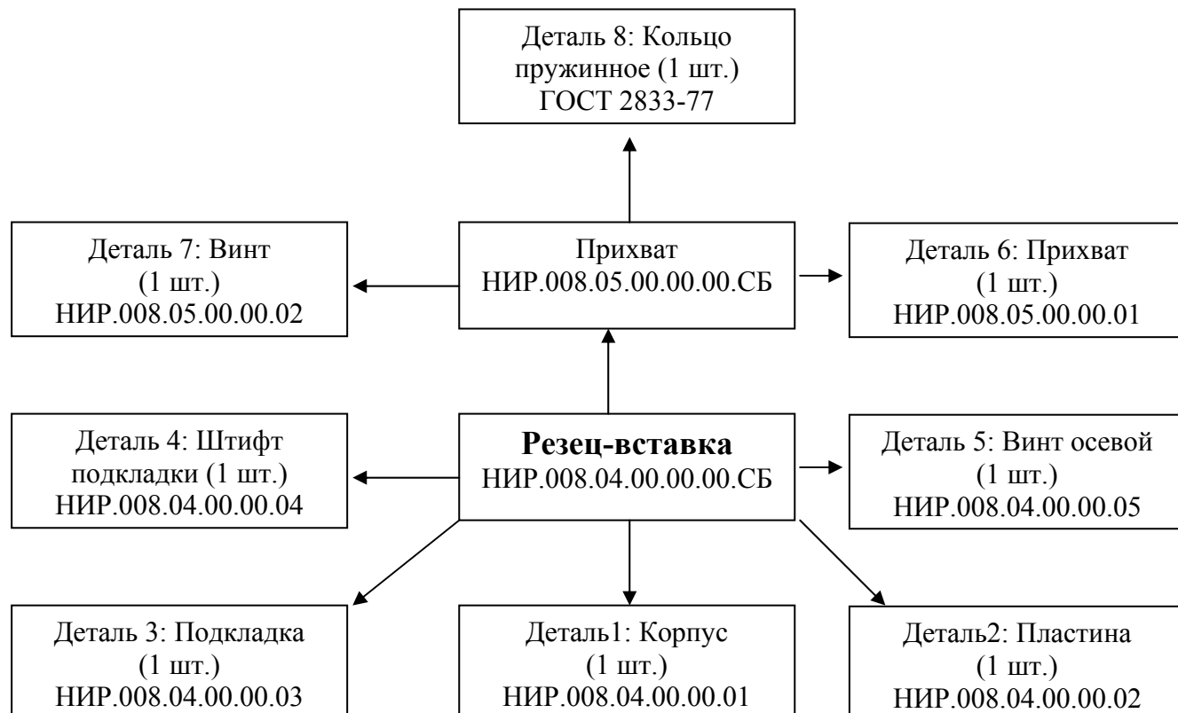
Рисунок 210 Схема сборки Резца-вставки
