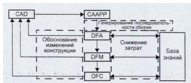
Рисунок 18. Концепция системы автоматизированного проектирования на базе методологии DFMA
